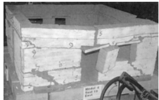
4-1 a 4-3 Grietas típicas producidas por impactos sísmicos simulados en modelos (Tolles et al. 2000)
