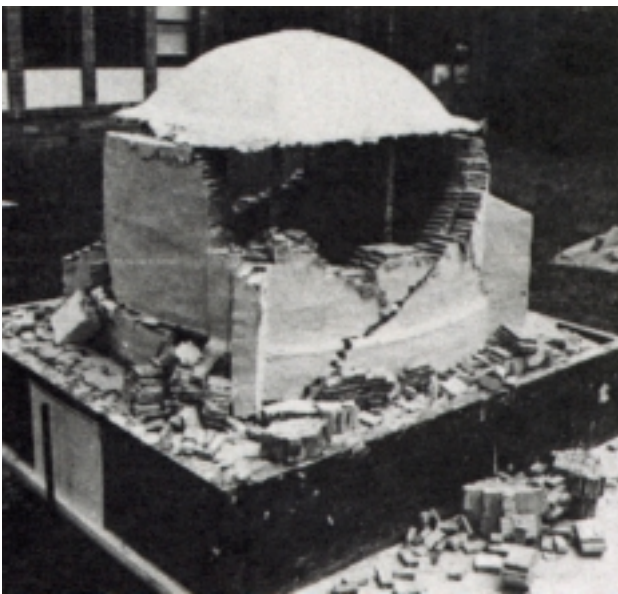
4-5 y 4-6 Modelos de la vivienda de la fig. 4-4 después de impactos sísmicos simulados (Sibtain, 1982)
